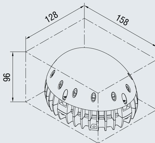
Крепежные отверстия в корпусе светильника
