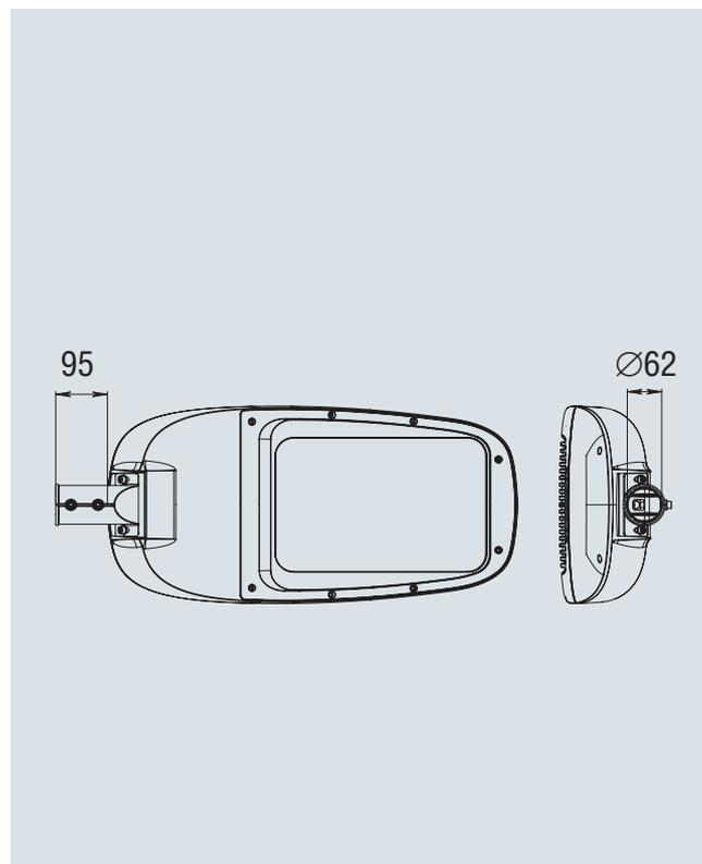
Светильники оснащены схемой управления по протоколу 1–10 В и могут быть использованы в автоматизированных системах управления освещением.
